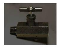
Вентиль ВПЭМ ВМ 5х35 применяется для подсоединения манометров, а также обеспечения возможности демонтажа манометра без сброса давления из основной линии, в качестве запорных устройств без разделителя сред на вторичных отводах арматуры и трубопроводах, отбора проб. Рабочее положение любое.
