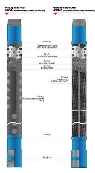
Противопесочные сетчатые скважинные фильтры устанавливаются в продуктивном пласте скважины и предназначены для фильтрации добываемого продукта от посторонних включений, предотвращения
