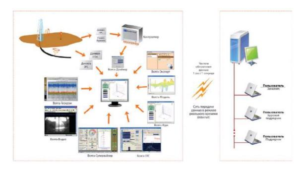
Аппаратно-программный комплекс «Волга» предназначен для автоматизированного контроля процесса бурения нефтегазовых скважин, проведения геолого-технологических и геохимических исследований, с целью оперативного управления бурением и обеспечения безаварийности и безопасности проводки скважин.
