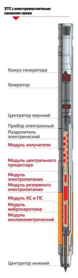
ЗТС с электромагнитным каналом связи устанавливается над забойным двигателем, состоит из забойной части (прибор электронный, генератор, удлинитель, электрический разделитель) и наземной аппаратуры (антенна, приемное устройство, ПК).
