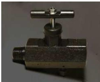
Вентиль ВПЭМ ВМ 5х35 применяется для подсоединения манометров, а также обеспечения возможности демонтажа манометра без сброса давления из основной линии, в качестве запорных устройств без разделителя сред на вторичных отводах арматуры и трубопроводах, отбора проб. Рабочее положение любое.
