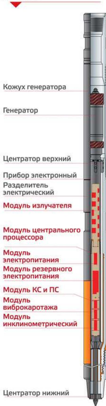
ЗТС с электромагнитным каналом связи устанавливается над забойным двигателем, состоит из забойной части (прибор электронный, генератор, удлинитель, электрический разделитель) и наземной аппаратуры (антенна, приемное устройство, ПК).
